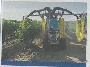
L'appareil présenté en capacité de 800 litres en format traîné fonctionne avec une pompe hydraulique. Équipée du kit environnemental lavage à la parcelle et munie de panneaux en matière composite, la machine pèse seulement 800 kilos. Sa ventilation fonctionne avec deux vitesses de rotation. Son prix varie, se-Ion option, de 25 à 30 000 €.
