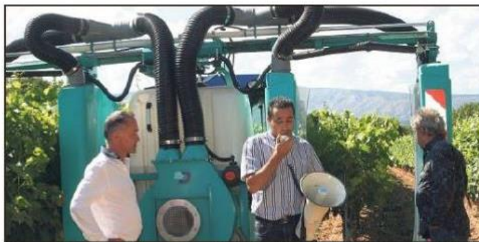
Une démonstration de pulvérisation confinée pour réduire l'impact des pesticides.
